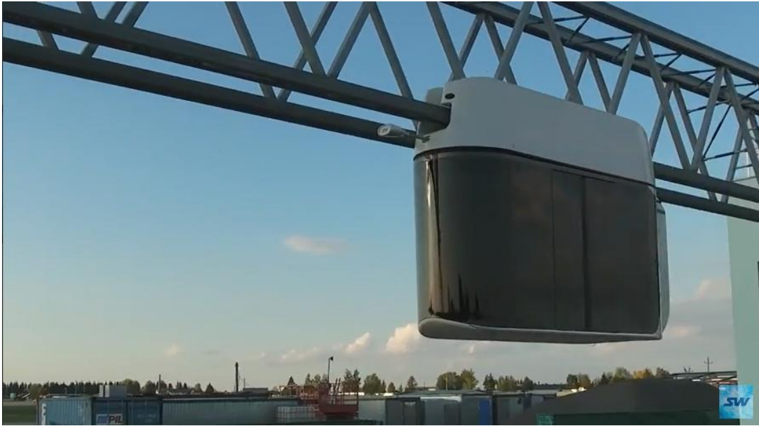
Рис. 4. Випробування 14 місцевого юнібуса на жорсткій рейковій структурі
