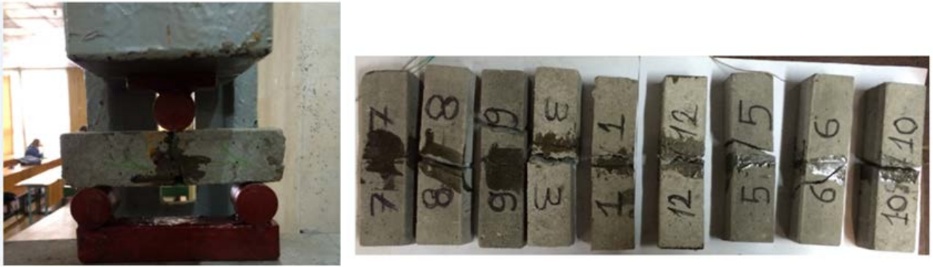
Рис. 2 Зразки відновлених балочок та метод їх дослідження на міцність при згині після витримки в кліматичній камері.
