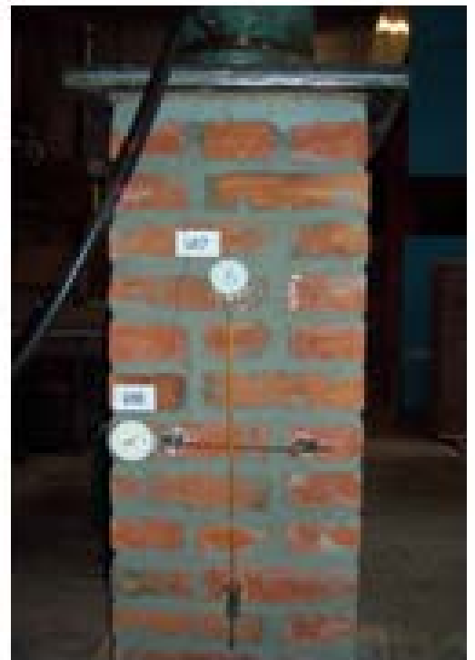
Рис.4. Дослідний зразок цегляної кладки та метод її дослідження.
