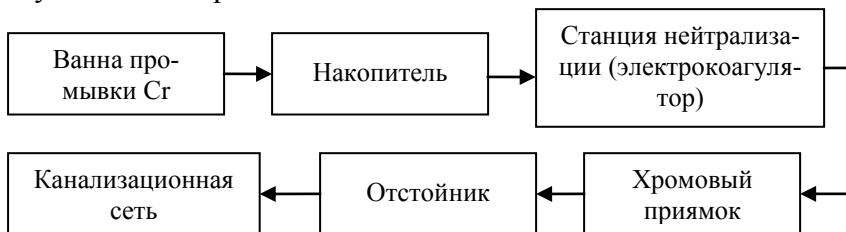
Рисунок 1 – Технологическая схема очистки сточных вод гальванического цеха
